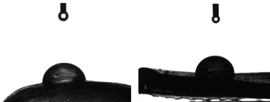
Rysunek 3. Proces zwilżania powierzchni zsyntezowanych materiałów wodą destylowaną; 3a – materiał hybrydowy bez dodatku nanocząstek; 3b – materiał hybrydowy z nanocząstkami złota.
