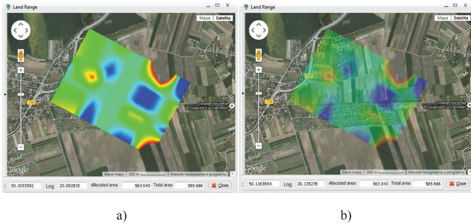
Rysunek 6.11. Wizualizacja badanego zjawiska na wskazanym obszarze; a) obraz nieprzezroczysty, b) obraz przezroczysty. Figure 6.11. Visualization of the phenomenon studied in the prescribed area; a) not transparent image, b) transparent image
