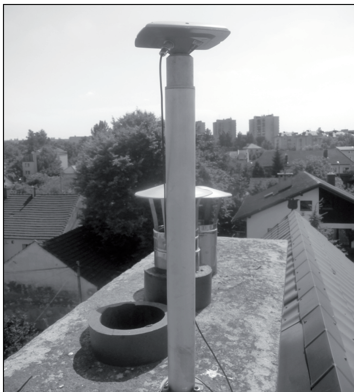
Rysunek 1. Antena Topcon PGA-5 na punkcie testowym Figure 1. Topcon PGA-5 antenna on test point
