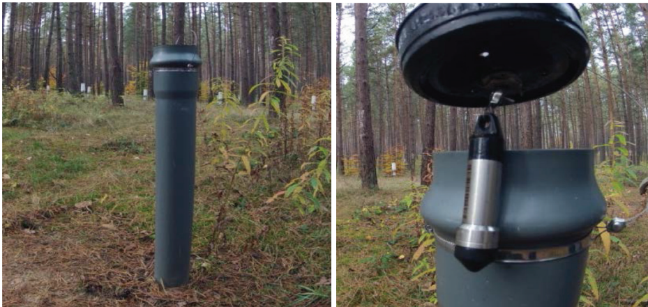
Rysunek 4. Studnia wiercona oraz sonda typu Mini-Diver Figure 4. Bored well and Mini-Diver type probe
