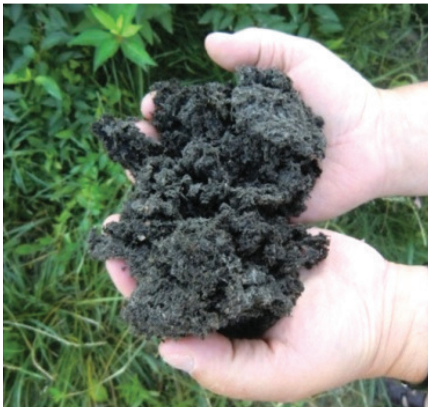
Fotografia 2. Osady ściekowe po odwodnieniu w badanej instalacji
