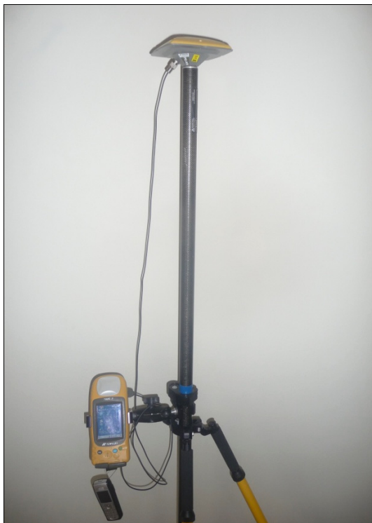
Rysunek 1. Zestaw pomiarowy Topcon GMS-2 z anteną zewnętrzną PG-A1 i modemem GSM
