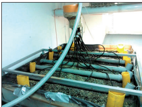
Fotografia 7. Model „M2” wraz z głowicą rozdzielczą (widoczne żółte przewody napowietrzające oraz popielate rozprowadzające ścieki wstępnie oczyszczone) Photo 7. “M2” model with the separation head (visible yellow aeration pipes and gray pre-treated sewage distribution pipes)
