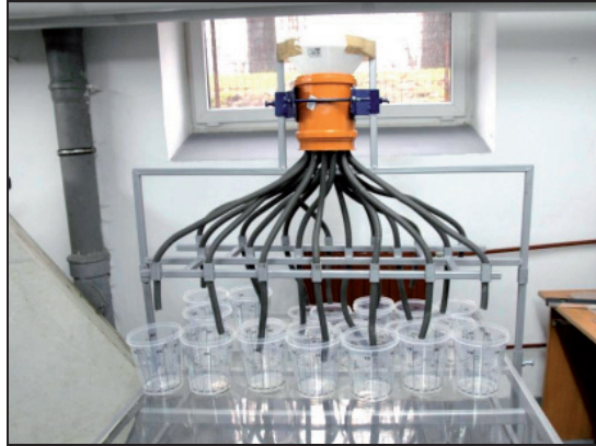
Fotografia 3. Model „R1” - urządzenie do badania efektywności rozdziału ścieków Photo 3. “R1” model - sewage separation efficiency - testing device
