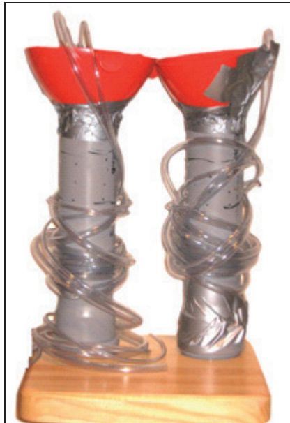
Fotografia 18. Urządzenia do poboru ścieków z zadanych głębokości złoża filtracyjnego Photo 18. Sewage collection devices from the selected depths of the filter bed
