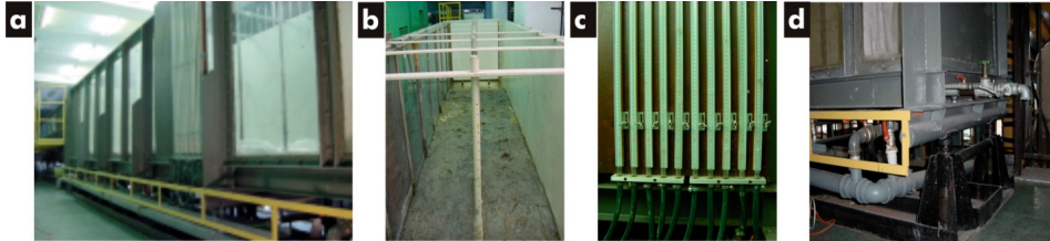
Rysunek 1. Średniowymiarowy aparat do badania filtracji przez modele nasypów: a) widok ściany czołowej, b) wnętrze aparatu z iłowym uszczelnieniem przydennym, c) tablica pomiarowa do odczytu poziomu wody w piezometrach, d) zawory pomiarowo-upustowe
