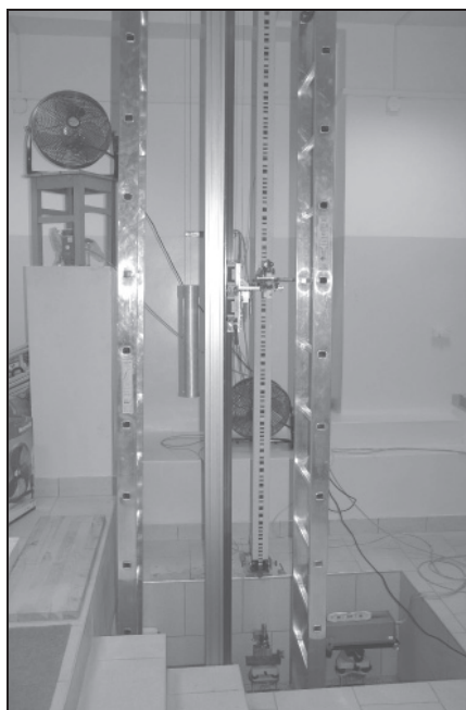
Rysunek 3. Widok komparatora pionowego – na dole widoczny interferometr laserowy Figure 3. View of vertical komparator – bottom visible laser interferometer
