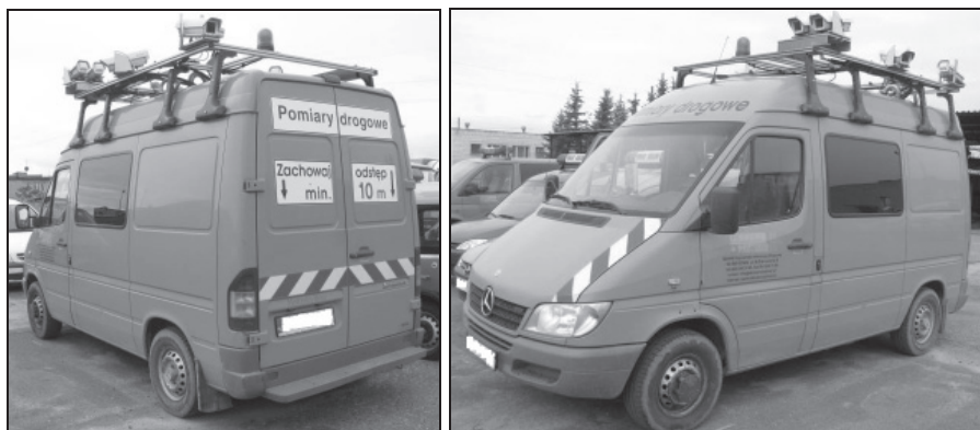
Rysunek 1. Samochód specjalistyczny wyposażony w sprzęt do inwentaryzacji drogowych (Ł. Tyburski)
