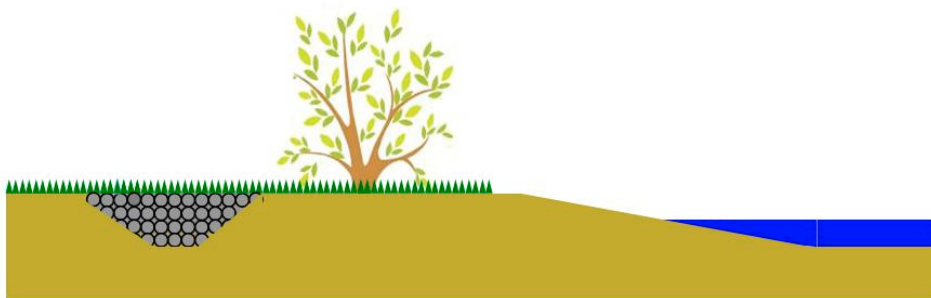
Rysunek 2. „Spiące” umocnienia brzegowe rzeki Izary Figure 2. „Slipping” bank protection structure of the Isar River
