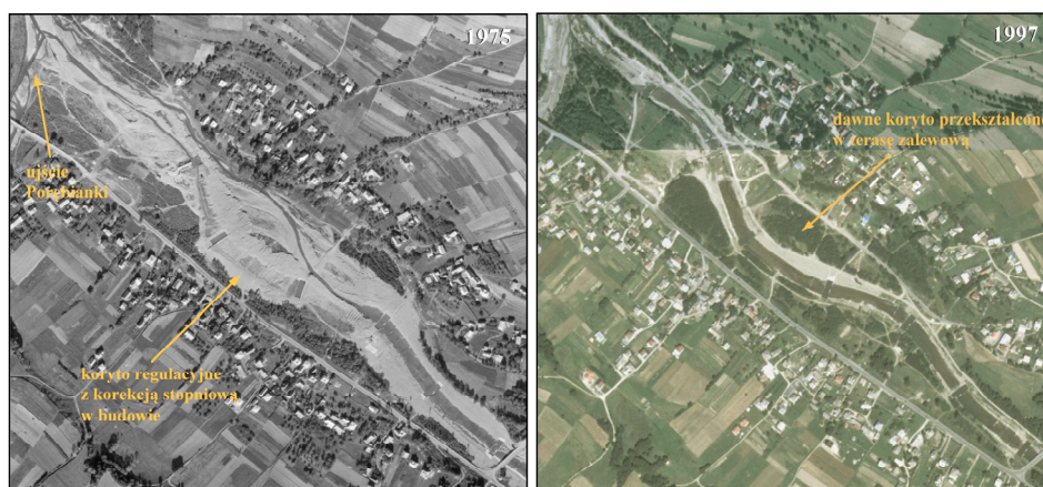
Rysunek 17. Koryto Mszanki w Mszanie Górnej w trakcie powstawania korekcji stopniowej w 1975 r. i zmiany koryta po 22 latach
