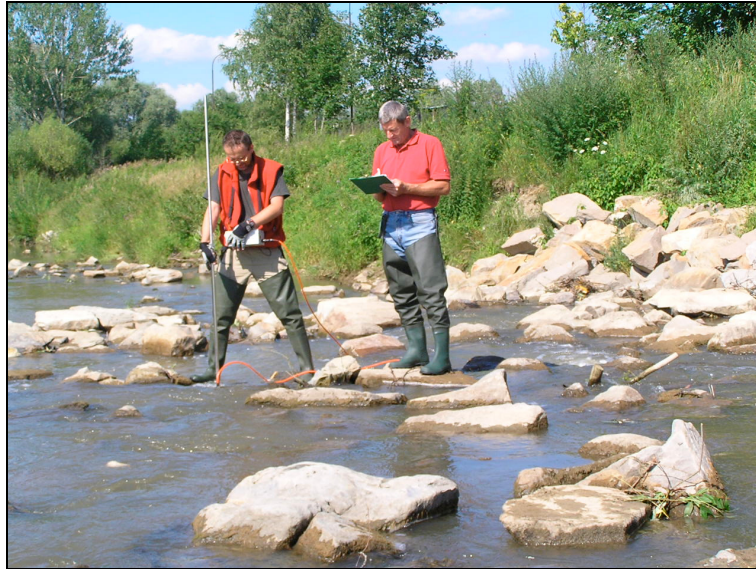
Fotografia 26. Ziarna ponadwymiarowe tworzące bystrze o zwiększonej szorstkości. Zdjęcie przedstawia pomiary hydrometryczne dokonywane w celu określenia warunków hydrodynamicznych w rejonie tych struktur (fot. A. Radecki-Pawlik)
