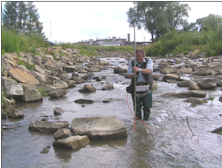
Fotografia 1. Pomiar prędkości wody urządzeniem NAUTILUS 2000 podczas określania rozkładów prędkości na bystrzu o zwiększonej szorstkości na potoku Sanoczek, fot. K. Huta
