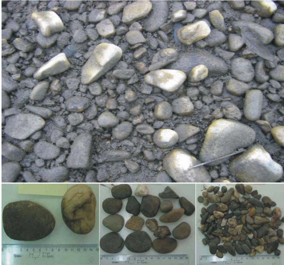
Fotografia 3. Obrukowane dno oraz frakcje tworzące bruk powyżej meandra nr I (fotografia R. Kasperek)
