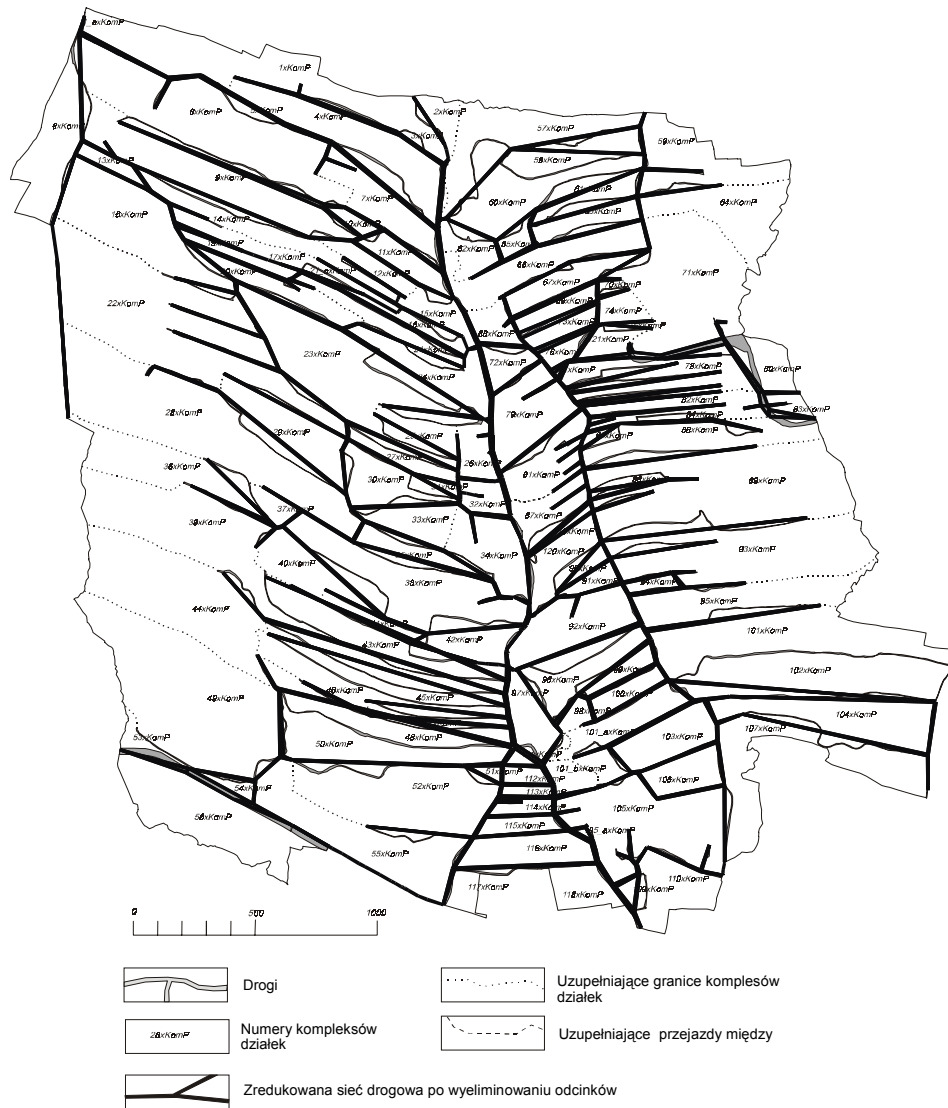
Rysunek 1. Zredukowana sieć drogowa po wyeliminowaniu odcinków przejazdowych
