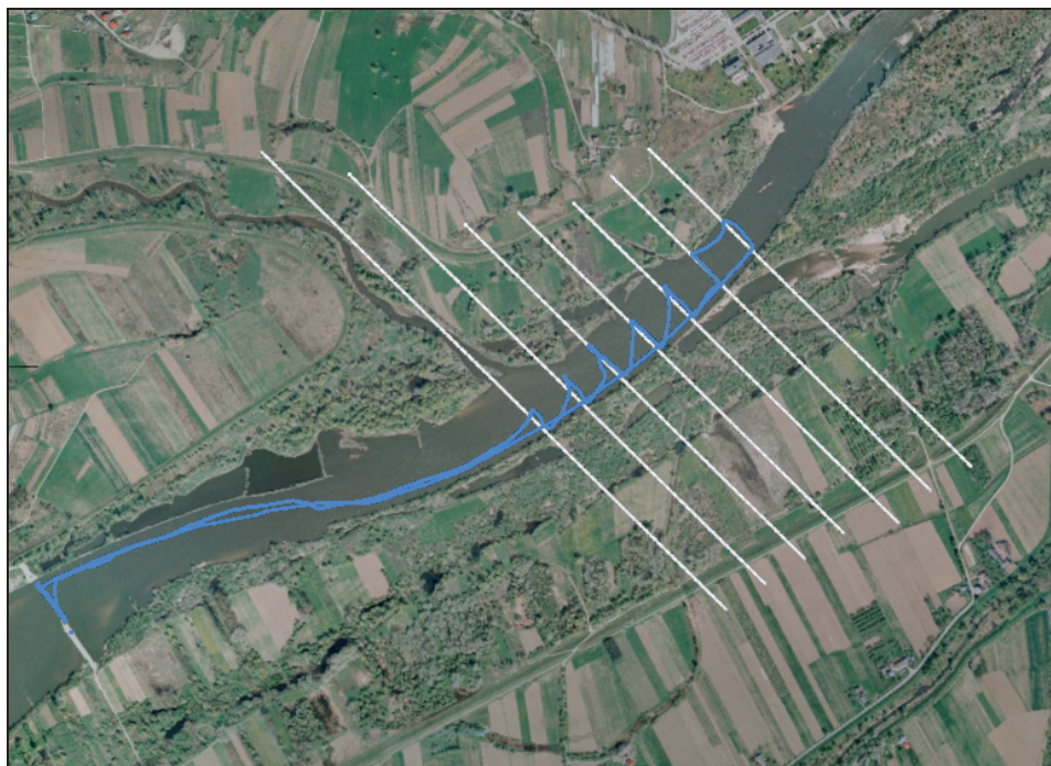
Rysunek 5. Kilwater zarejestrowany pracującym na pokładzie odbiornikiem GPS Figure 5. Wake recorded by GPS receiver working on board
