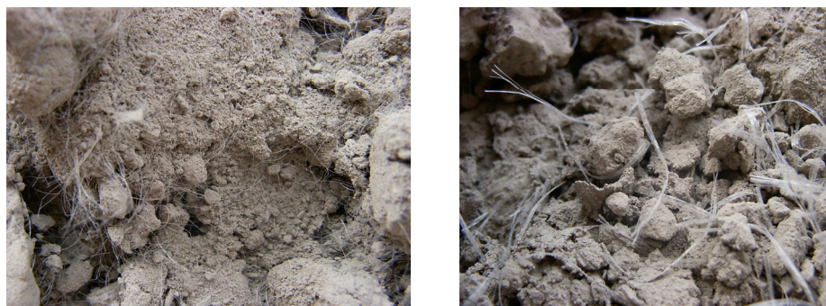
Fotografia 1. Popiół lotny z dwoma rodzajami zbrojenia: z lewej cienkie włókna polipropylenowe (średnica ok. 118 \mu\text{m} ); z prawej włókna polipropylenowe, cięte i fibrylowane (średnica ok. 100 \mu\text{m} )
