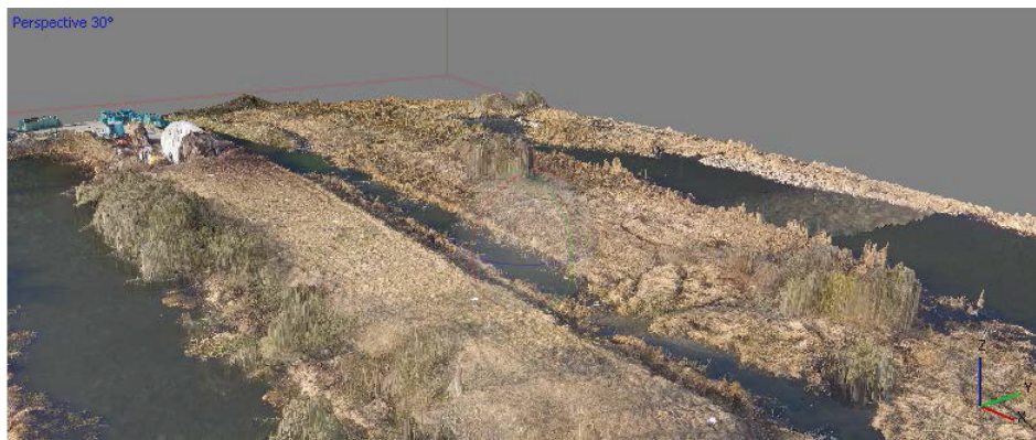
Rysunek 10. Model 3D wykonany na podstawie zdjęć z UAS.
