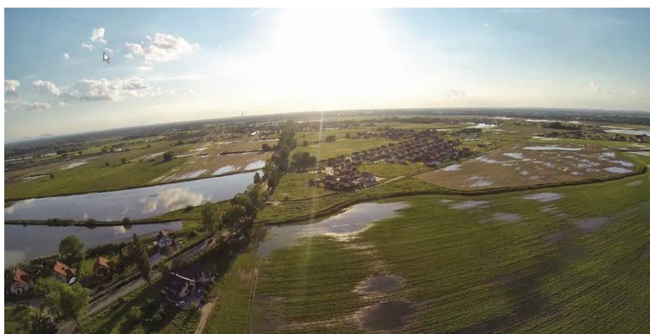
Rysunek 5 i 6. Miłoszyce gm. Jelcz-Laskowice. Podtopienia będące skutkiem niedrożnych rowów melioracyjnych i bądź ich zniszczenia. Fot. W. Jabłoński Figure 5 and 6. Miłoszyce municipal Jelcz-Laskowice. Flooding resulting from clogged ditches and or their destruction.
