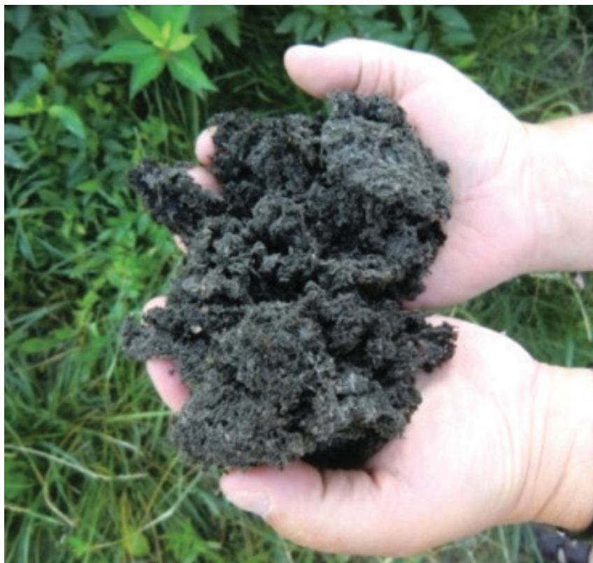
Fotografia 2. Osady ściekowe po odwodnieniu w badanej instalacji
