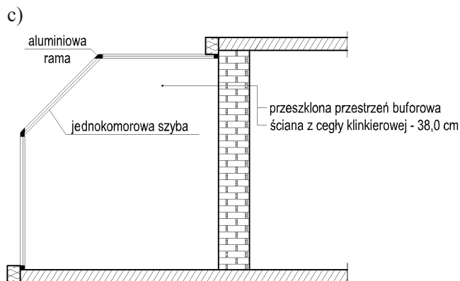
Rysunek 3. Przekroje ścian z przyjętymi rozwiązaniami pozyskującymi energię słoneczną; a) ściana z oknami (SO), b) ściana akumulacyjna z cegły klinkierowej (CK), c) ogród zimowy (OZ)
