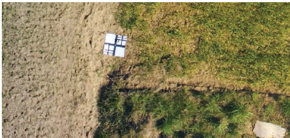
Rysunek 4. Punkt polowej osnowy fotogrametrycznej na fragmencie ortofotomozaiki z pikselem (GSD) 0,007 m.
