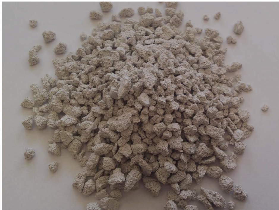
Rysunek 1. Beton komórkowy użyty do badań Figure 1. Autoclaved aerated concrete used in study
