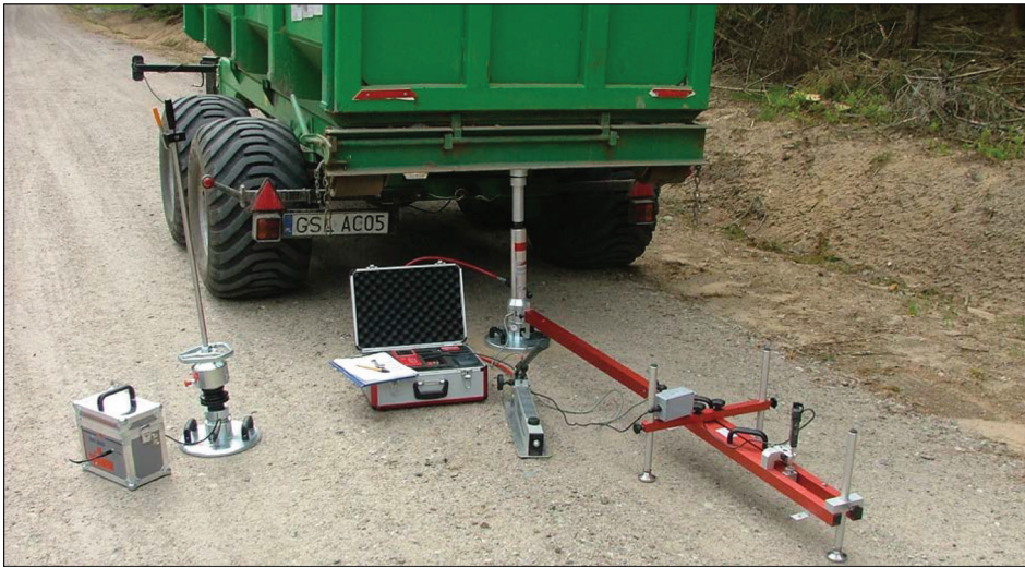
Rysunek 1. Lekka płyta dynamiczna – po lewej i płyta statyczna – po prawej stronie (fot. S.M. Grajewski)
