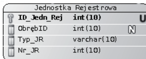
Rysunek 3. Struktura encji JEDNOSTKA REJESTROWA w notacji UML 2.0
