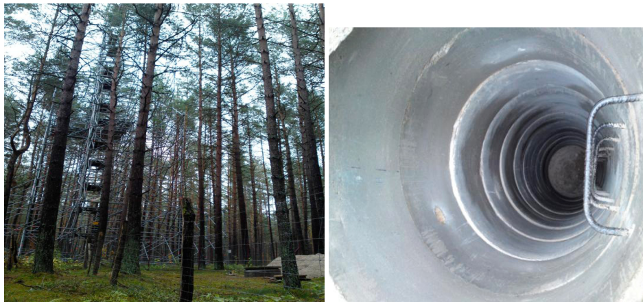
Rysunek 7. Studnia betonowa do pomiaru uwilgotnienia metodą TDR (punkt pomiarowy A – przy Wieży) (fot. A. Krysztofiak-Kaniewska) Figure 7. Concrete well for the TDR measure (measurement point A - the Tower) (fot. A. Krysztofiak-Kaniewska)
