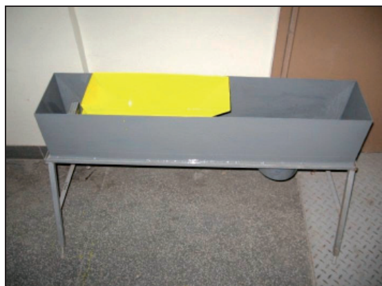
Fotografia 11. Korytko wywrotne – do dozowania ścieków
