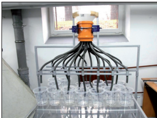
Fotografia 3. Model „R1” - urządzenie do badania efektywności rozdziału ścieków
