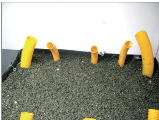
Fotografia 6. Model „M2” - warstwa zabezpieczająca i przewody napowietrzające Photo 6. “M2” model - protection layer and aeration pipes
