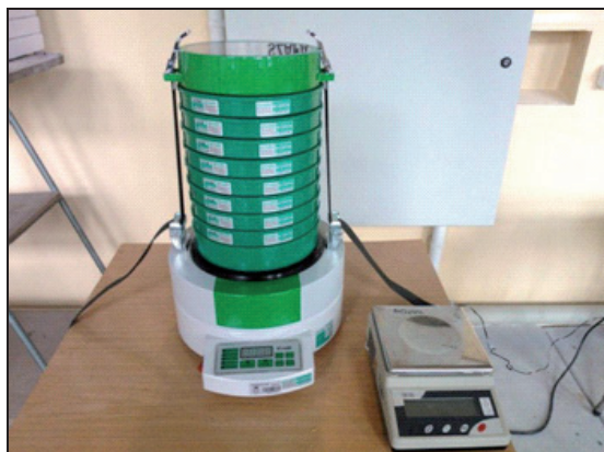
Fotografia 16. Wytrząsarka do gruntów sypkich Photo 16. Shaker for non-cohesive grounds
