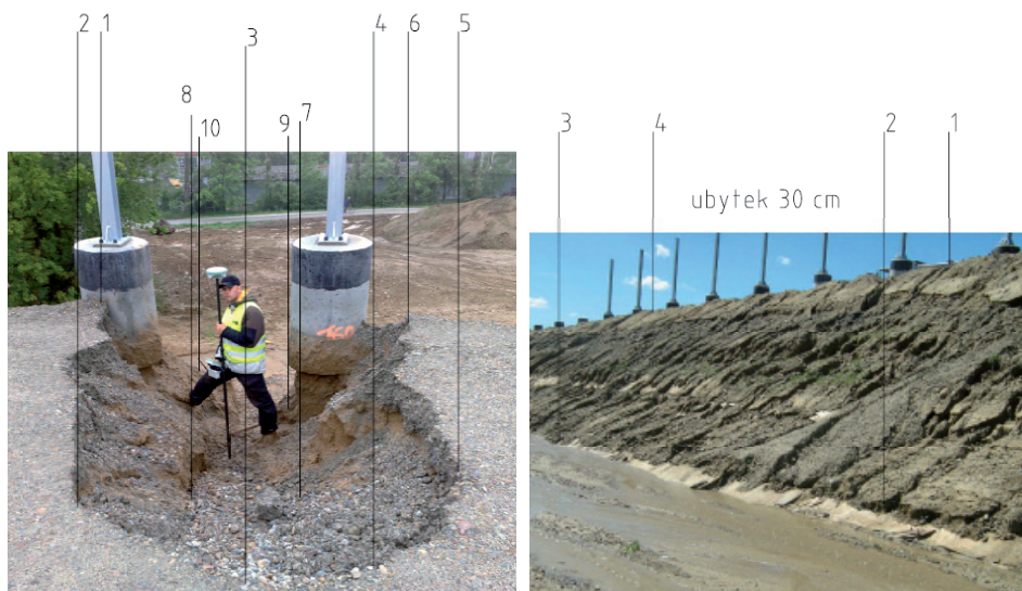
Rysunek 1. Schemat rozmieszczenia pikiet. Figure 1. The schema of spot height deployment
