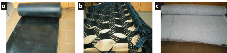
Rysunek 3. Materiały geosyntetyczne zastosowane w modelu nr II i III; a) geosyntetyczna bariera polimerowa, b) geosyntetyk komórkowy, c) geokompozyt drenażowy Figure 3. Geosynthetics materials applied in the models II and III a) polymeric geosynthetic barrier, b) geocell, c) draining geocomposite
