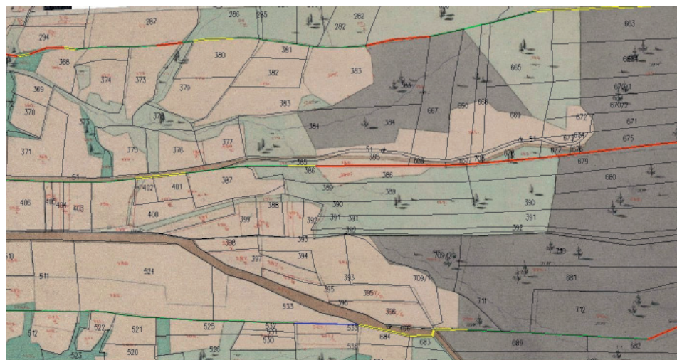
Rysunek 2. Różnice w przebiegu na przetworzonej mapie byłego katastru austriackiego w stosunku do obecnej mapy ewidencji gruntów i budynków Figure 2. The differences between boundaries on processed former Austrian cadastre map and present map of land and buildings records
