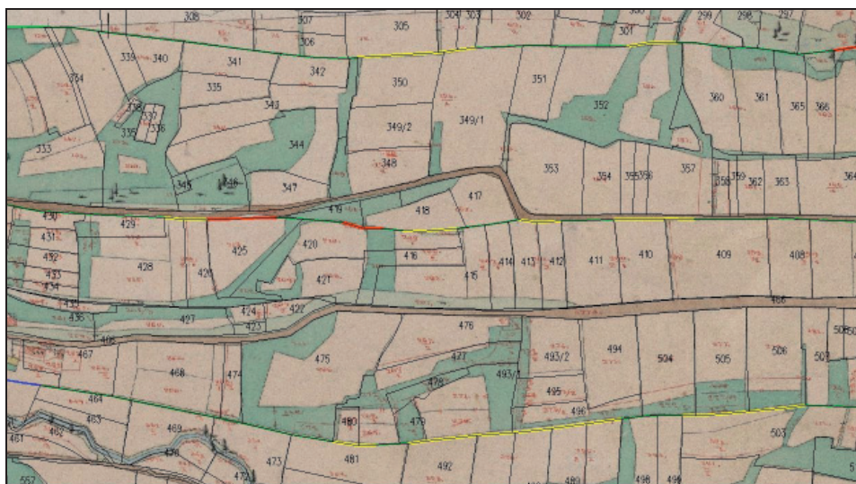
Rysunek 1. Różnice w przebiegu granic na przetworzonej mapie byłego katastru austriackiego w stosunku do obecnej mapy ewidencji gruntów i budynków Figure 1. The differences between boundaries on processed former Austrian cadastre map and present map of land and buildings records
