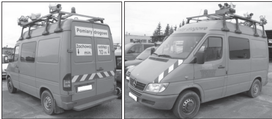
Rysunek 1. Samochód specjalistyczny wyposażony w sprzęt do inwentaryzacji drogowych (Ł. Tyburski)
