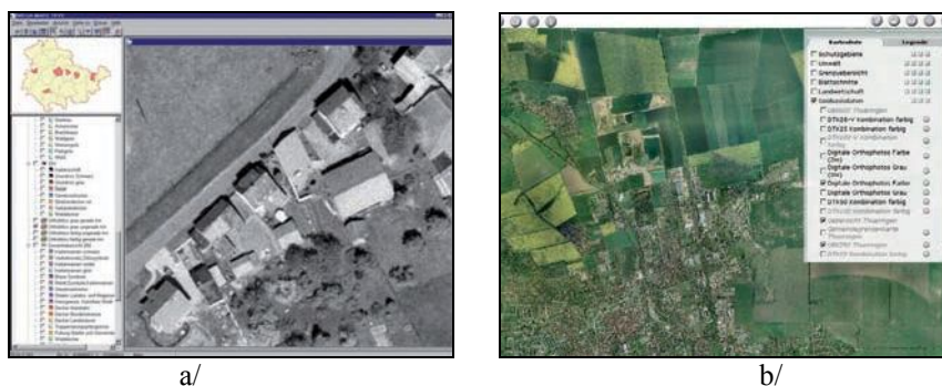
Rysunek 15. Okno Geoproxy – ortofotomapa a/panchromatyczna b/ barwna Źródło: www.geoproxy.geoportal-th.de
