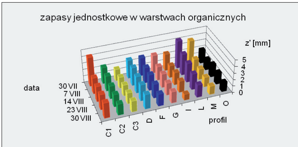
Rysunek 3. Zapasy jednostkowe wyliczone dla warstw organicznych profili glebowych Figure 3. Unitary water storages calculated for organic layers of profiles
