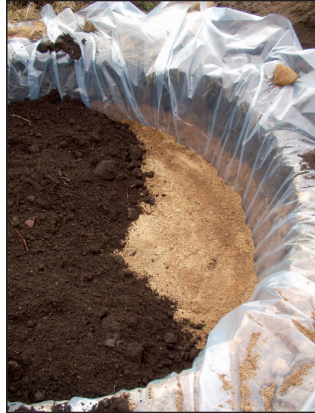
Fotografia 2. Wyizolowana geomembraną gleba w kołowej powierzchni doświadczalnej
