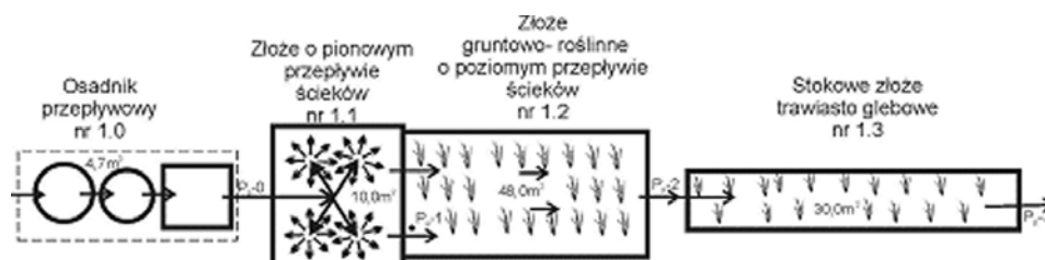
Rysunek 1. Schemat technologiczny zagrodowej oczyszczalni ścieków we wsi Muszynka
